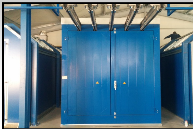
Manual winged doors, oil heated oven Manualne drzwi skrzydłowe, piec zasilany olejem opałowym
