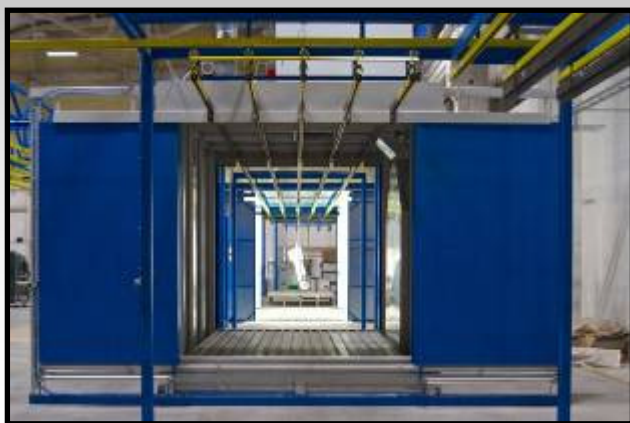
Automatic sliding doors, gas heated oven. Automatyczne przesuwne drzwi, piec zasilany gazem.
