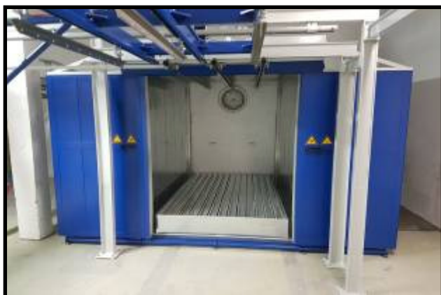
Manual sliding doors, electric heated oven. Manualne przesuwne drzwi, piec zasilany elektrycznie.
