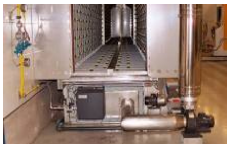
SYSTEM WYMIENNIKA CIEPŁA WBUDOWANY W WANNĘ PROCESU
