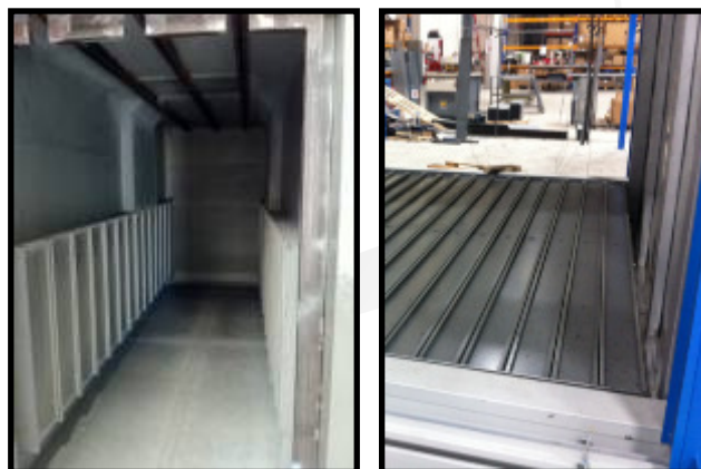
Air distribution from oven walls or floor. Rozprowadzanie powietrza od ścian lub podłogi.
